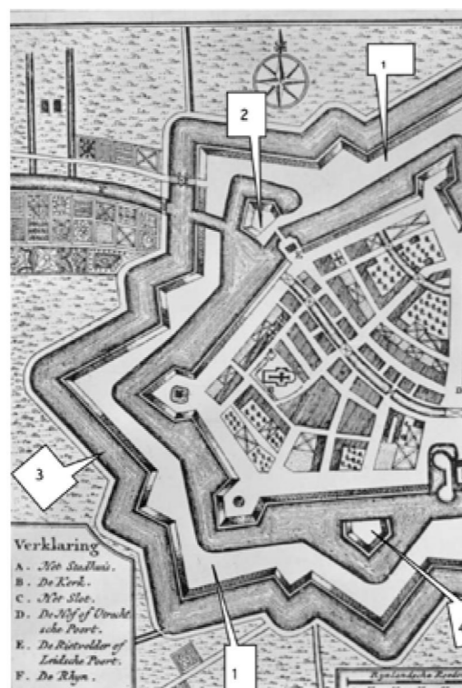
Woerden omstreeks 1750 . Omvorming retranchement tot een enveloppe (1), omvorming halve manen tot ravelijnen (2), aanleg stervormige singel met pad eromheen (3).
