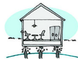
Grondwaterpeil te laag: paalrot
