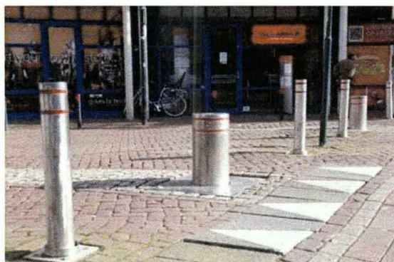
Afbeelding 4: Afsluiting met een dynamische paal
