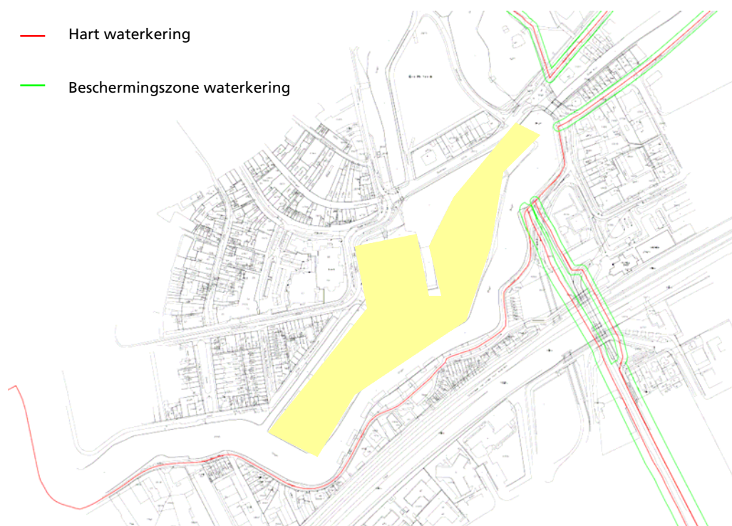
Fig. 5.3. Waterkeringen, inclusief beschermingszones
