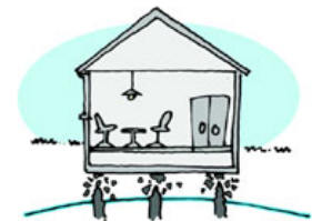
Grondwaterpeil te laag: paalrot
