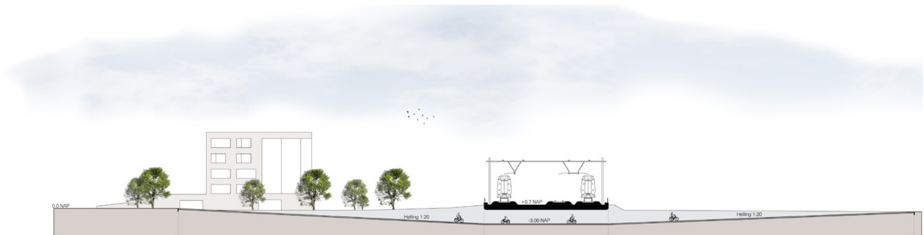
doorsnede langzaamverkeer tunnel t.p.v. reservering (knippen rijbaan)
