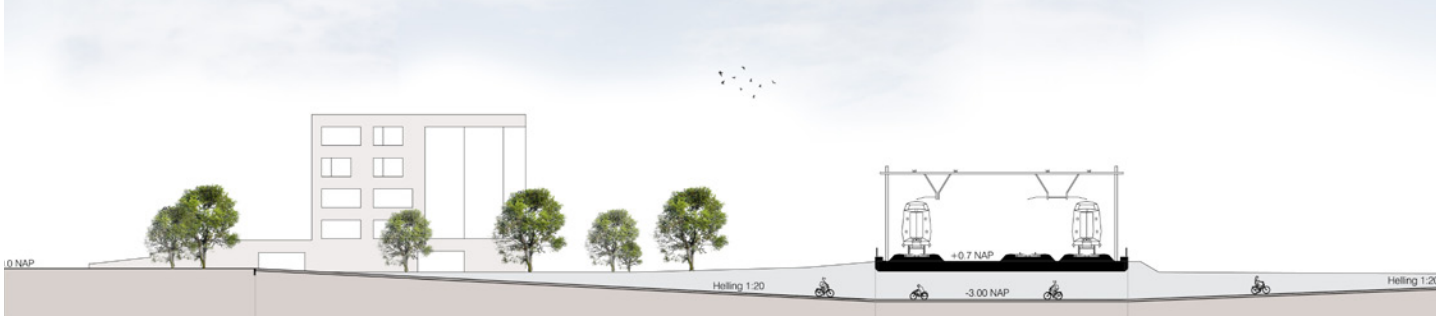
doorsnede 5b: Doorsnede reservering t.p.v. mogelijke toekomstige fietstunnel (optie knippen weg spoorzone)
