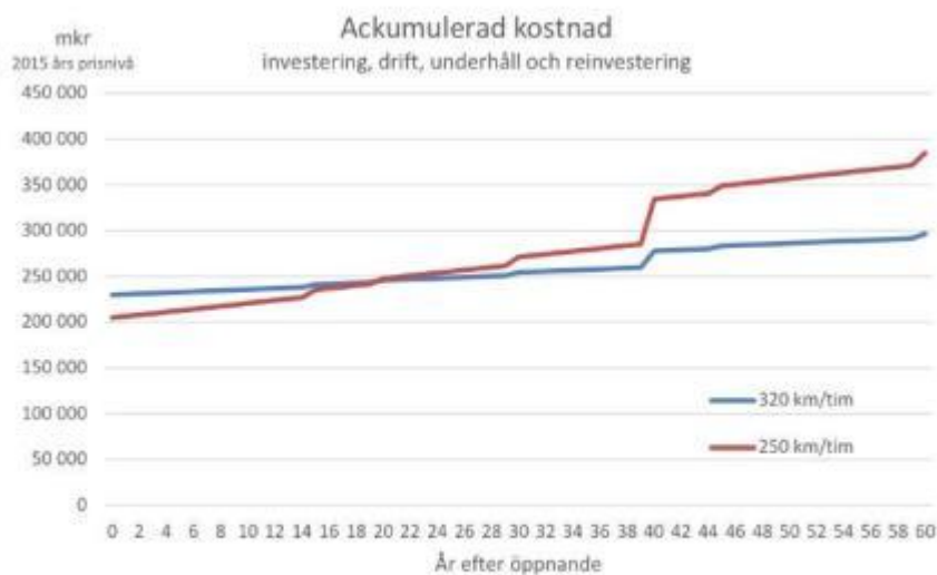
Figur 1. Ackumulerad kostnad för investering, drift, underhåll och reinvestering för UA320 respektive UA250.
