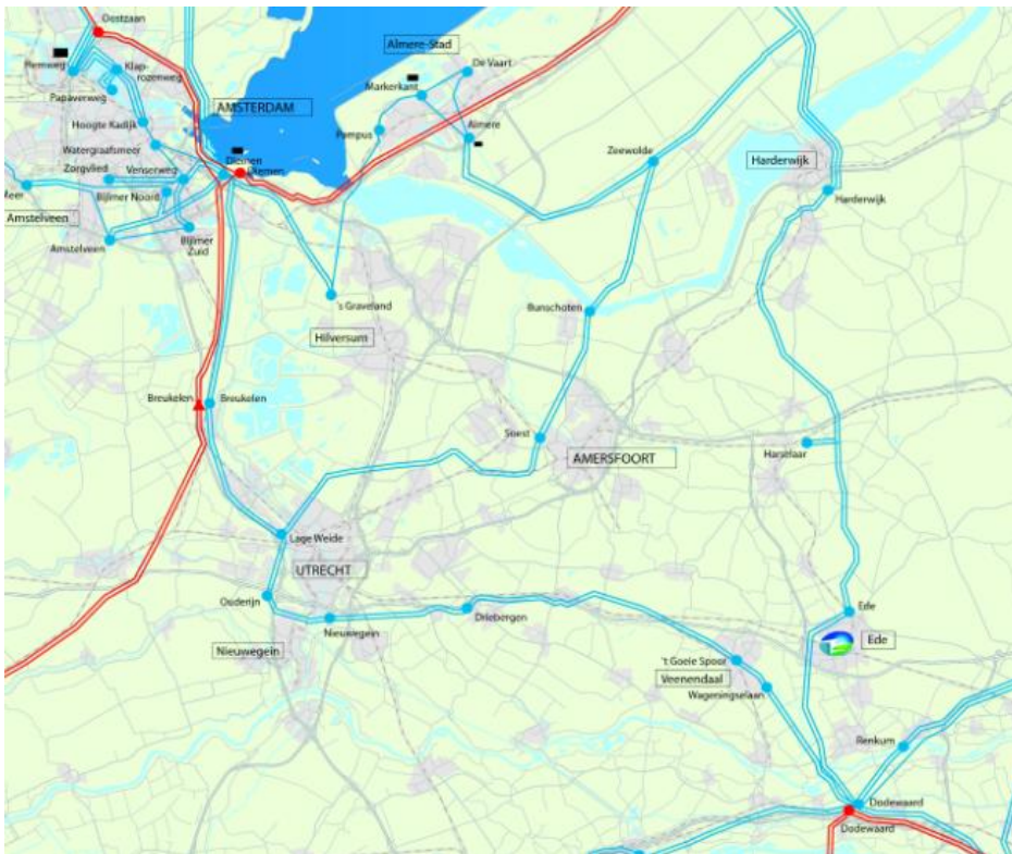
Figuur 9.1: Overzicht regionaal distributienet elektriciteit
