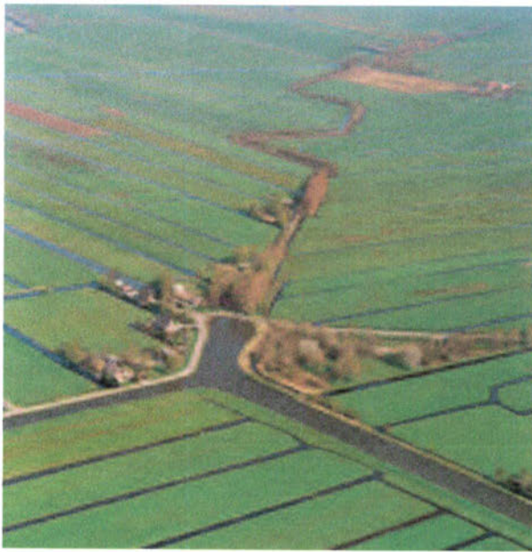
De Bijleveld met de Dooyersluis en de begroeide Veenkade als waterscheiding tussen de verschillende ontginningen.
