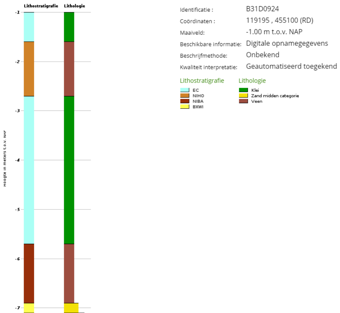
Afbeelding 7.1 Boormonsterprofiel B31D0924 genomen aan de Touwslagerweg
