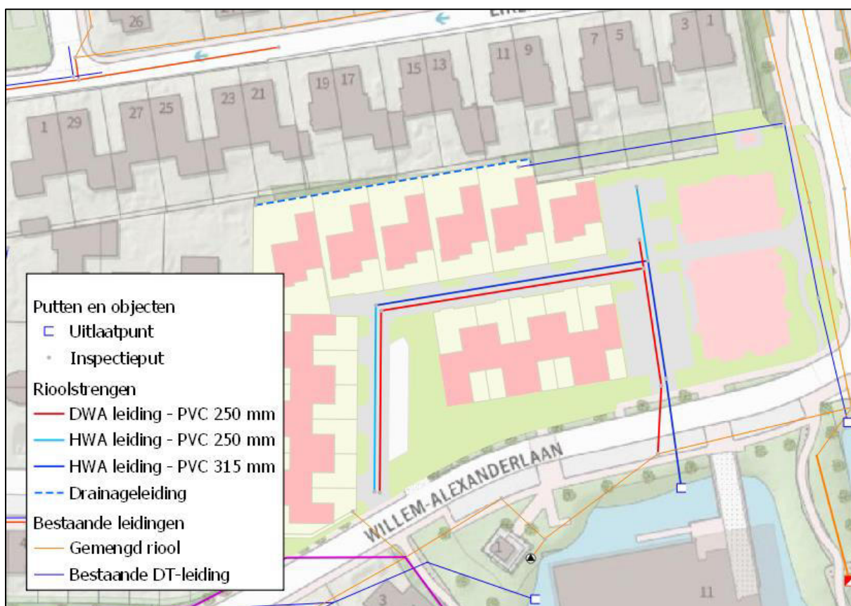
Afbeelding 3-1: Rioolontwerp met bestaande riolering.
