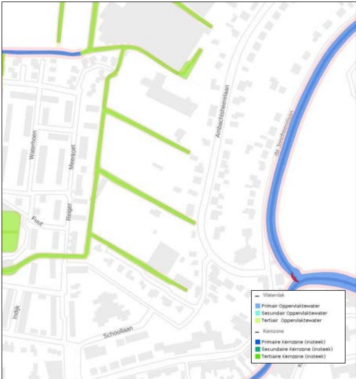
Afbeelding 3-2: De aanwezige watergangen zijn allen tertiaire watergangen, er bevinden zich geen waterhuishoudkundige kunstwerken in het gebied.
