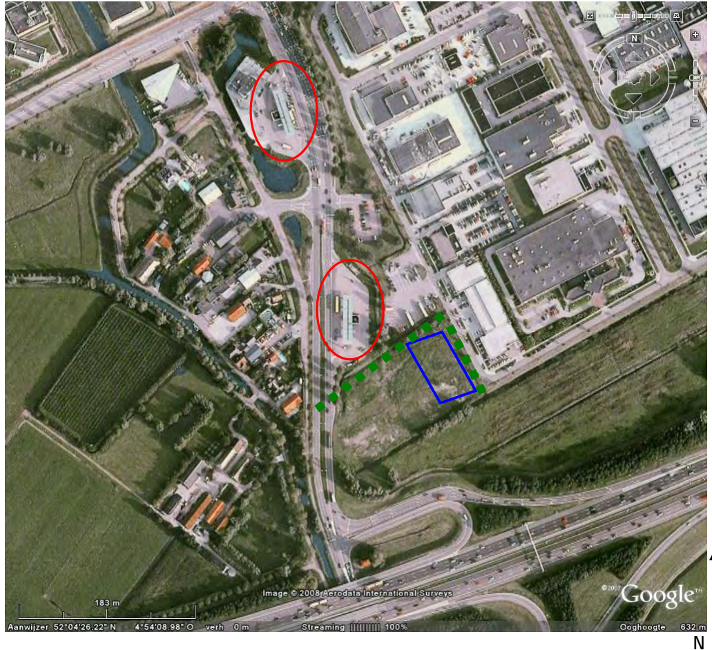
Figuur 2.1 Omgevingsplattegrond LPG-tankstation Europabaan In de rode ellips bevinden zich de verschillende deelstations van het tankstation. Het vulpunt en het reservoir bevinden zich bij het zuidoostelijke gedeelte. In groen is de hogedrukaardgasleiding aangegeven. De locatie van de geplande busremise is in blauw aangegeven.
