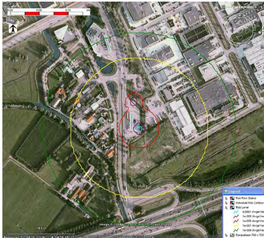
Figuur 4.1 Berekende plaatsgebonden risico voor een doorzet van 2.000 \text{ m}^3/\text{jaar}
