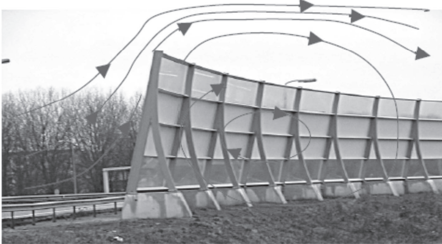
Figuur 6: Werking van schermen ("turbulentie" en "opstuwing") grafisch weergegeven (bron: Toepassingsadvies, IPL-1b)
