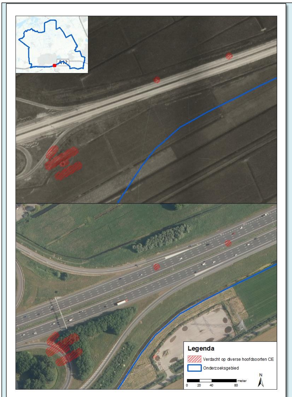
Afbeelding 51: Naorlogse ontwikkelingen in de op diverse gedumpte CE verdachte gebieden bij Polanen aan de zuidelijke grens van de gemeente Woerden. Te zien is dat de A12 naorlogss verbreed is en dat de op- en afritten verlengd en verplaatst zijn.
