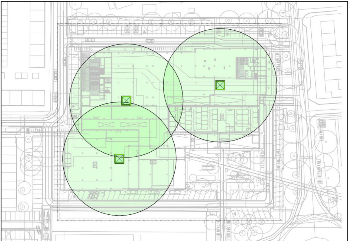
Figuur 4: Opzet met drie bouwkranen
