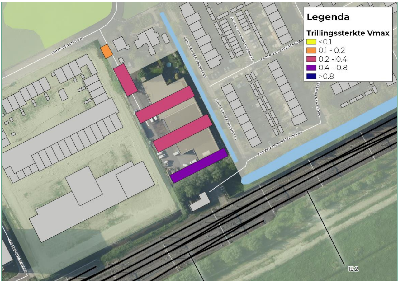
Figuur 8 Bovengrens van de trillingssterkte V_{max}
