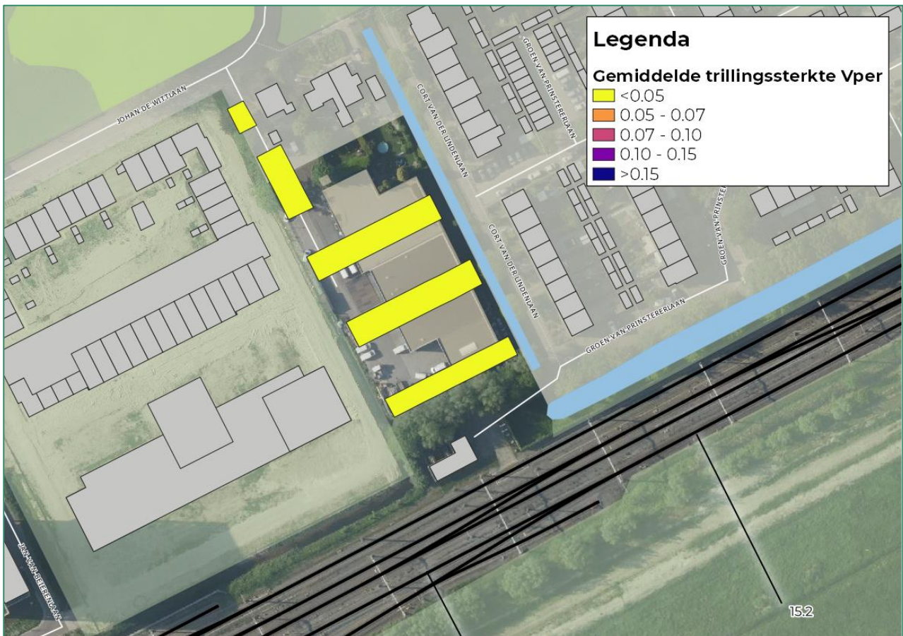
Figuur 9 Bovengrens van de gemiddelde trillingssterkte V_{per}
