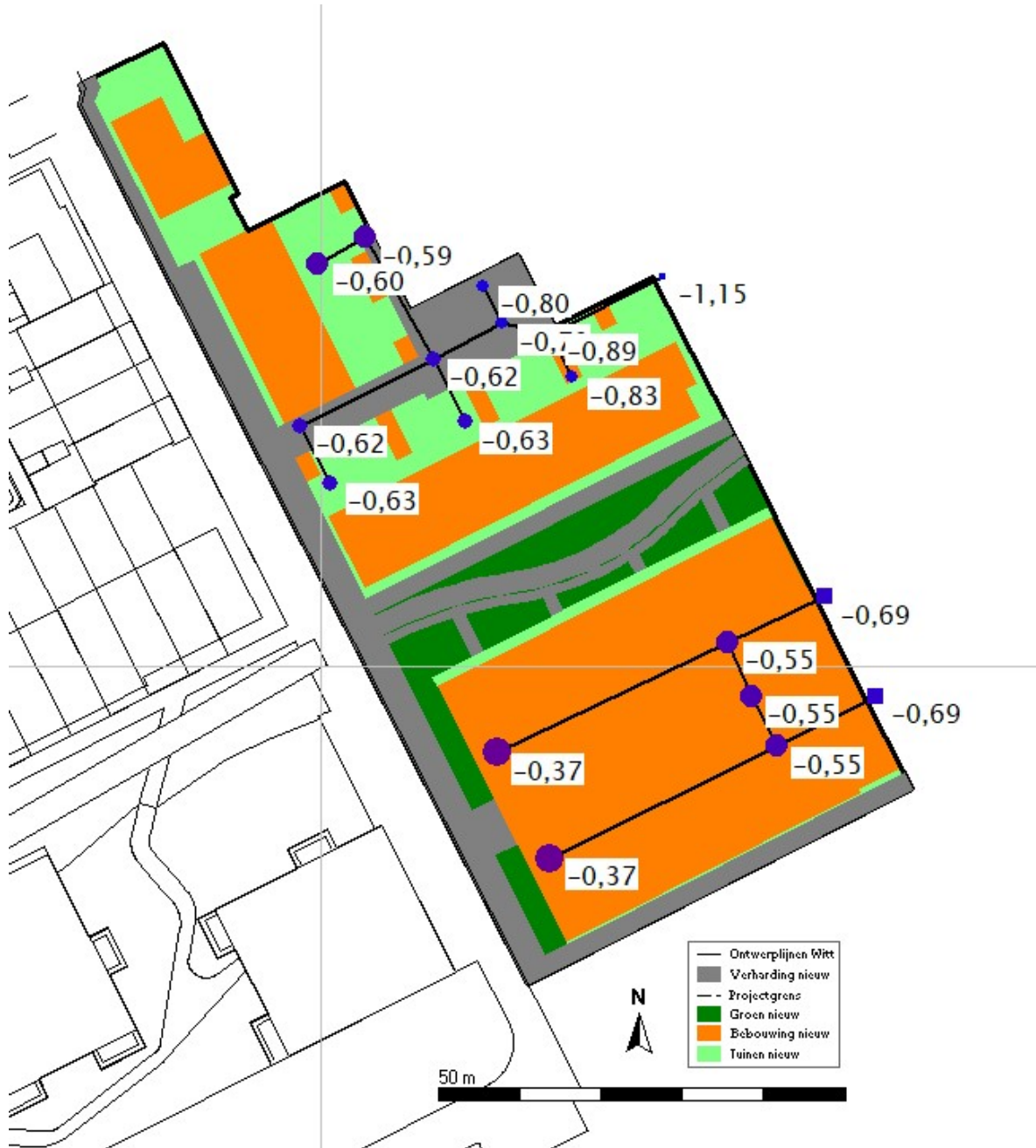
Figuur 5.3: Stijghoogte in het ontworpen stelsel bij een neerslag gebeurtenis van 90 mm in een uur. (ondergrond is indicatief)
