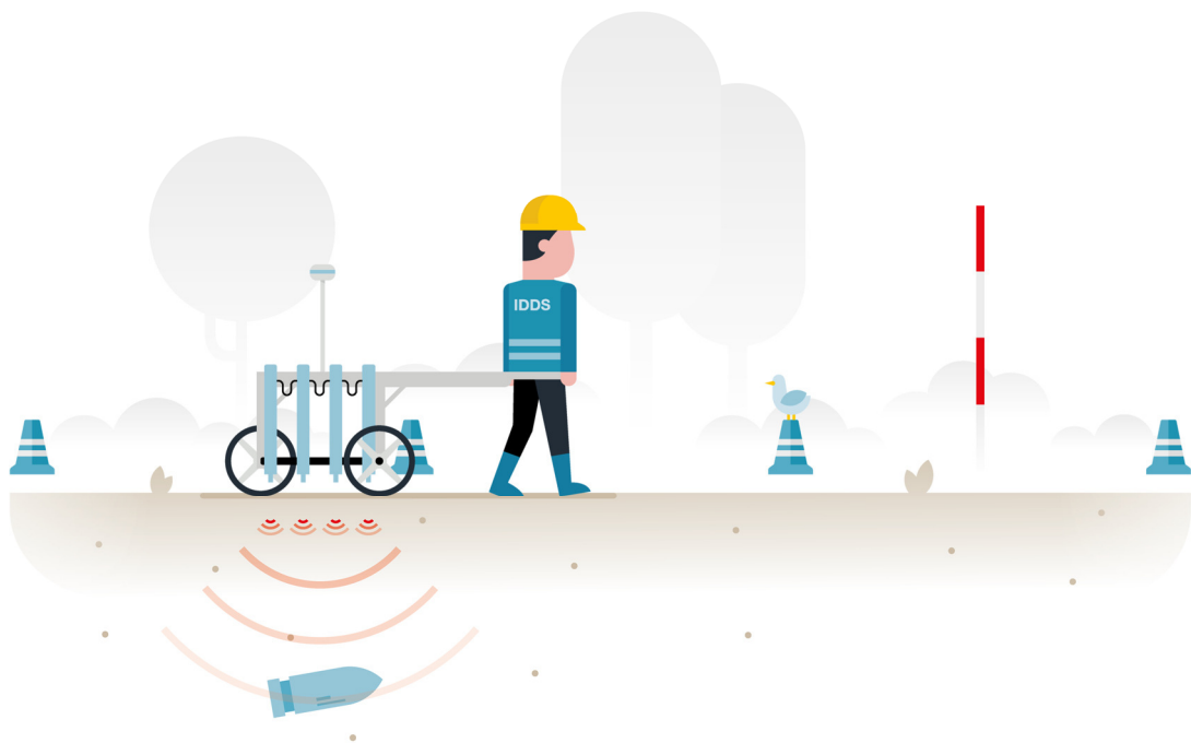
Figuur 27: Werkingsprincipe oppervlakedetectie middels een Multi sonde opstelling.
