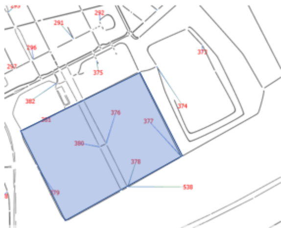
Figuur 5.9: Aansluitpunten op het netwerk van het vergelijkingsgebied in het verkeersmodel Woerden
